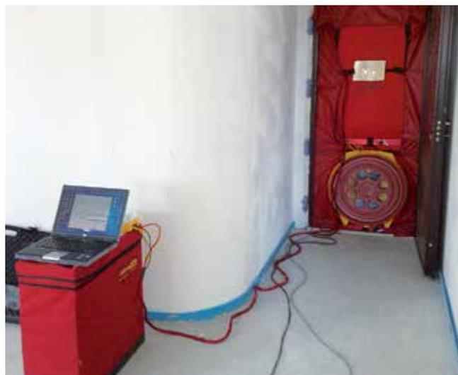
La tenuta all'aria di un edificio può essere verificata mediante il **Blower Door Test**
